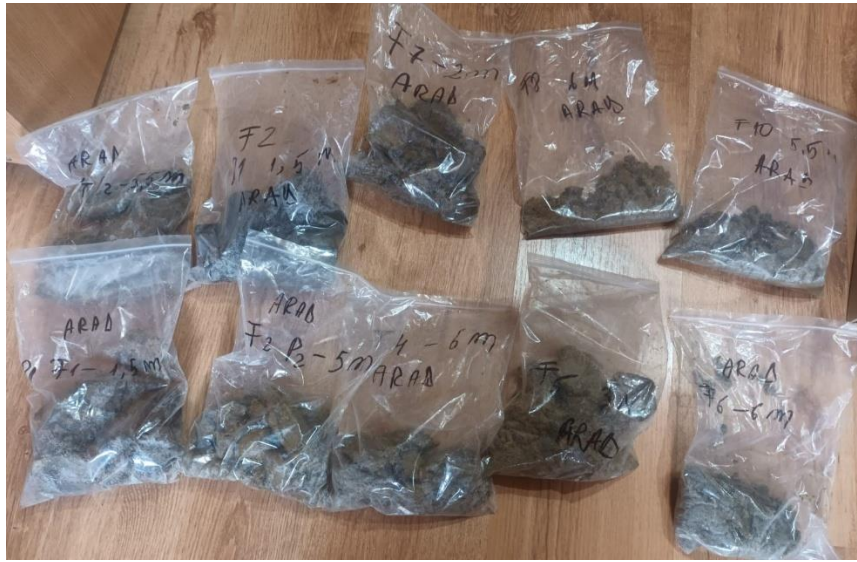
Fig.16. Probe tulburate recoltate din forajele executate
